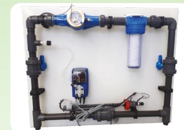
Station de traitement de l'eau par l'injection de dioxyde de chlore
